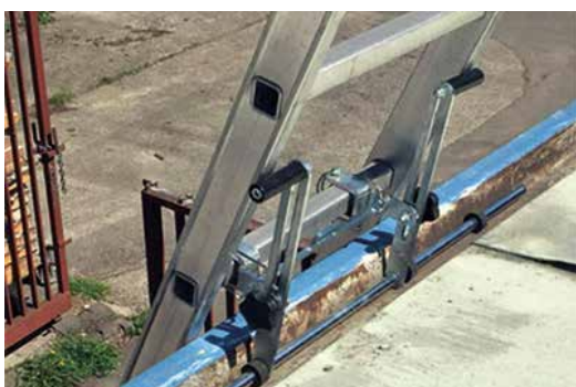
Sicherung beim Flachdach
